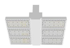
LED-Hallenleuchte für schwierige Anwendungen, modulare Bauweise, 6 Module inklusive LED-Konverter, elektronischem Vorschaltgerät, Gehäuse aus hochqualitativem, korrosionsbeständigem Aluminiumdruckguss in Farbe weiß, Abdeckung aus PC mit exzellenter chemischen und UV-Beständigkeit für anspruchsvolle Industrieanwendungen, 190 lm/w Systemeffizienz, Schutzart IP65, Umgebungstemperatur: -20°C bis +70°C
